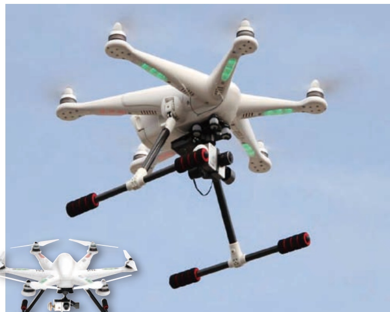
メガソーラー上空からの撮影に最適な、高解像度のカメラを搭載したラジコンヘリコプター。最長25分の飛行が可能。
